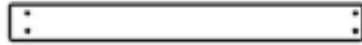
H7 PANNEAU DE BANC - W4L17658 (x2) 1 po x 2 3/8 po x 3 po (24x60x583)
