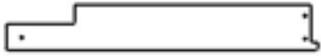
H6 PANNEAU DE BANC - W4L17657 (x2) 1 po x 3/8 po x 23 po (24x86x583)
